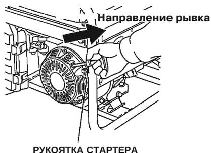
6. Если во время пуска рычаг управления воздушной заслонкой устанавливался в положение ЗАКРЫТО, по мере прогрева двигателя постепенно переводите его в положение ОТКРЫТО.
